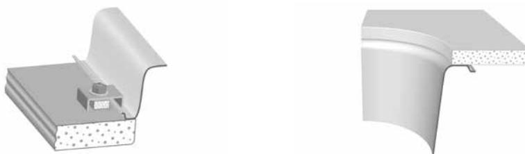
Überprüfen Sie, ob der Ausschnitt für das INOX-Spülbecken geeignet ist und stellen sie ihn auf die gewünschte Position ein. Dann werden auf die Ränder des INOX-Spülbeckens vorbereitete Trägerschrauben geklebt, auf einer Distanz von je 10 bis 15 cm.
