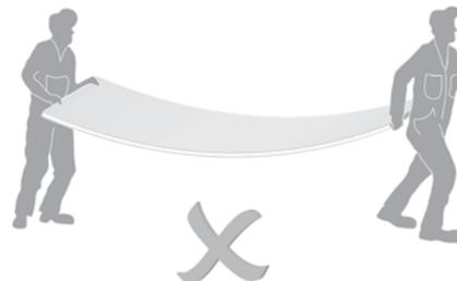
Die Kerrockplatten müssen einzeln getragen werden und zwar vertikal, weil eine Hand als Stütze dient und die andere zur Kontrolle. Für das Tragen von Lasten empfehlen wir die Nutzung von Vakuumeräten.
