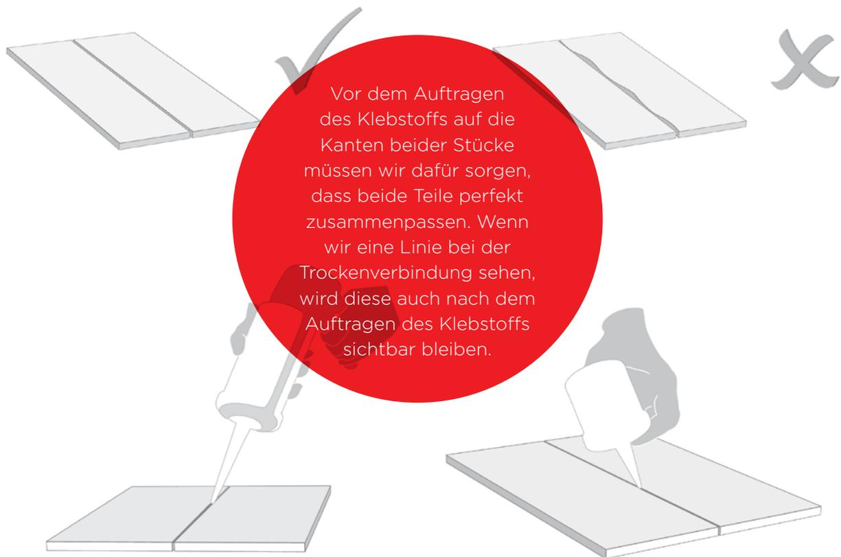
Die Stücke, die geklebt werden, legt man auf eine gerade Unterlage mit der Oberseite nach oben und lässt eine Spaltöffnung von 2 bis 3 mm. Wir empfehlen eine Schablone aus Material, auf dem der Kerrock Klebstoff nicht klebt (PE, Aluminium, Iveral gewachstes oder selbstklebendes Papier...). Den Klebstoff trägt man reichlich in die Spaltöffnung zwischen den beiden Elementen auf, und drückt sie bis zur gewünschten Lage zusammen.
