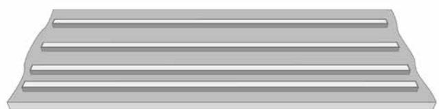
Die Unterkonstruktion kann nur mit Längsverstärkungen ausgeführt werden und zwar so, dass die Trägerelemente auf die Vorder-, Mittel- und Rückseite gestellt werden.
