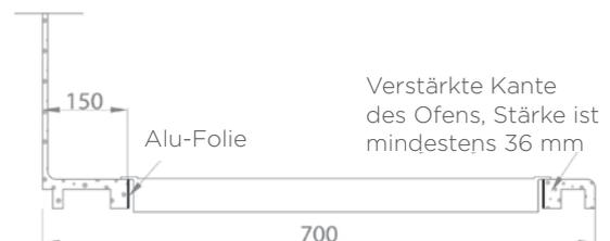
An einer Arbeitsplatte der Breite von =600 mm kann eine Wandverkleidung aus Kerrock montiert werden, aber diese darf nicht starr mit der Arbeitsplatte verbunden werden. Sie wird elastisch, wie auf der Abbildung dargestellt ist, befestigt.
